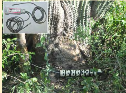
Figura 3. Modelos de PVC con forma y tamaño de Heloderma sp registrando la temperatura. En el recuadro se muestra un registrador de temperatura tipo data logger.
