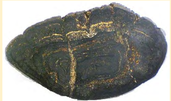
Figura 2. Sección transversal de un nódulo polimetálico. Al centro un núcleo de arcilla, alrededor capas concéntricas de birnessita y asbolán. Colectado durante la campaña MIMAR VI.
