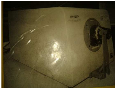
Figura 16. Colorímetro, donde se muestra la parte donde se realiza la medición de las muestras sólidas.
