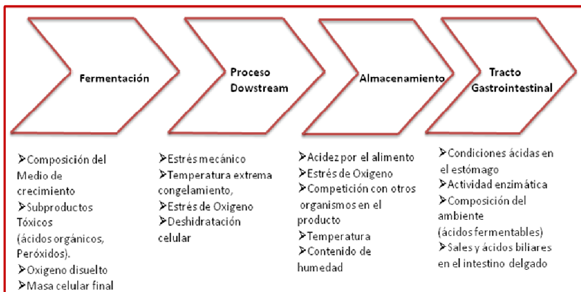
Figura 2. Factores principales que afectan la viabilidad de probióticos desde la producción hasta el tracto gastrointestinal. Tomado: Lacroix y Yildirim, 2007.
