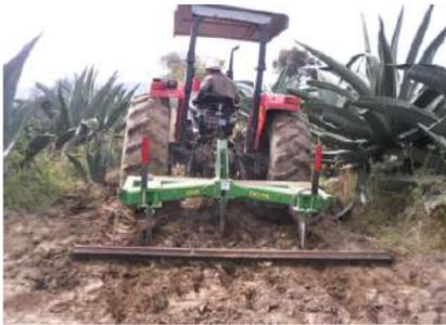
Ilustración 10. Preparación de terreno, proceso de subsuelo
