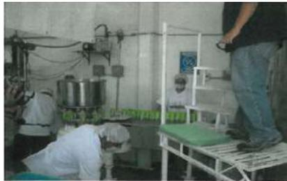
Ilustración 28. Llenado, sellado y enlatado del pulque, introducción de Nitrógeno para evitar abolladuras
