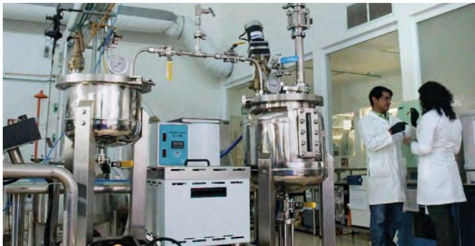
▲ **Reactor enzimático** de la planta piloto de fermentación del Centro de Asistencia en Tecnología y Diseño del Estado de Jalisco, A.C. (Unidad Zapopan).
