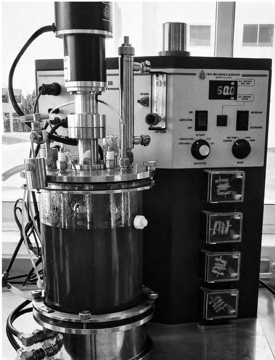
▲ **Estudio de la fermentación de mostos** a base de jugo de agave a nivel laboratorio en un bioreactor, en Centro de Investigación y Asistencia en Tecnología y Diseño del Estado de Jalisco, A.C. (Unidad Zapopan).
