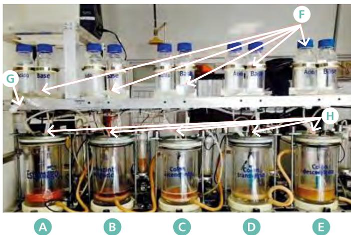
**Figura 2.6** Sistema ARIS: A) Estómago, B) Intestino delgado, C) Colon ascendente, D) Colon transversal, E) Colon descendente, F) Reguladores de potencial de hidrógeno, G) Inyector de muestra, H) Toma de muestras. Cortesía: Ricardo García Gamboa (Instituto Tecnológico de Tepic).
