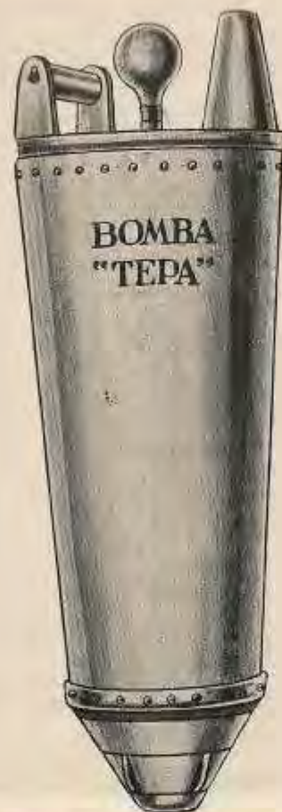
Figura N.º 27.—Bomba extractora de aguamiel "Tepa", ideada por el Autor para substituir al incómodo y antihigiénico acocote .
