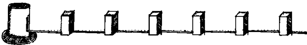
Fig 57. Arcas en la cañería (Báez)
