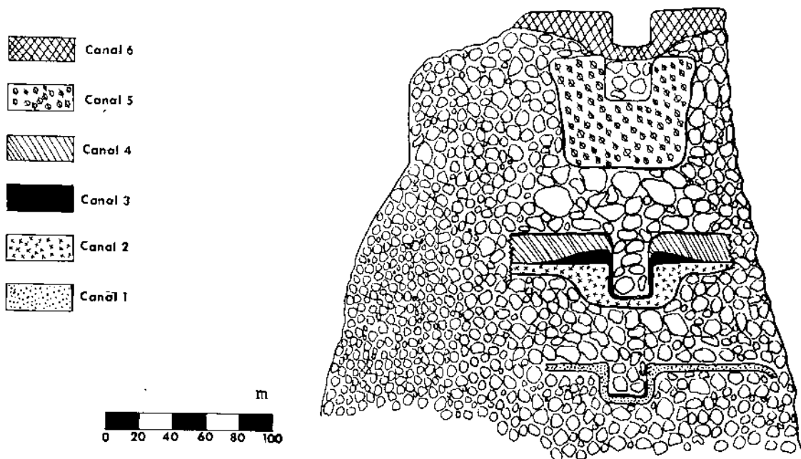
Fig 15. Canales superpuestos del acueducto que llegaba a Tezcotzingo (Parsons)
