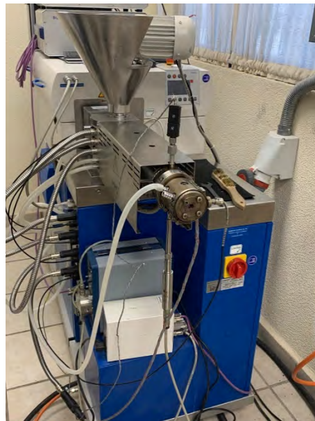
Figura 3. Extrusor CW Brabender Instrument, Modelo KE 19/25 D
